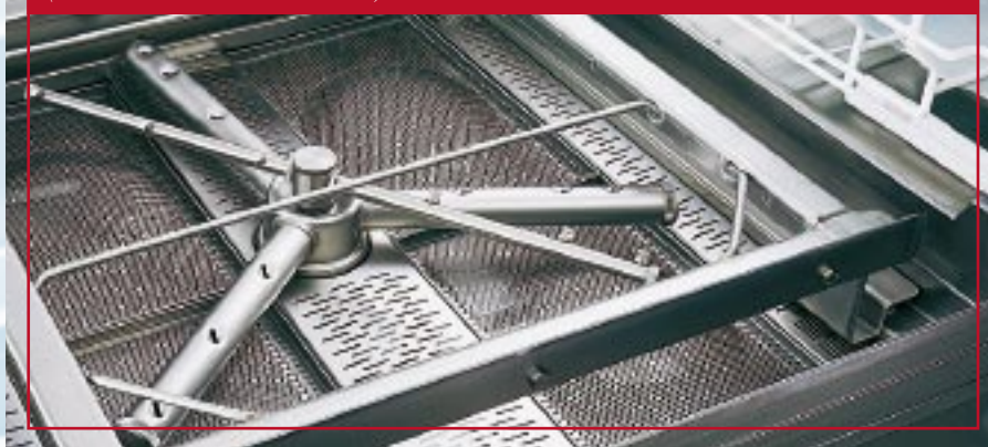
Doppel-Flächen-Siebsystem mit rotierendem Drei-Fügel-Wascharm (z.B. Serie GSC 400 und 600)
